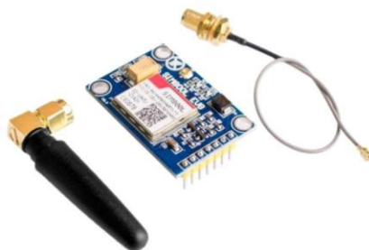
Sl. 6. ARDUINO GSM/GPRS telekomunikacioni modul
