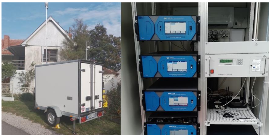
Sl. 2. Mobilna merna stanica sa automatskim analizatorima za merenje gasovitih polutanata
