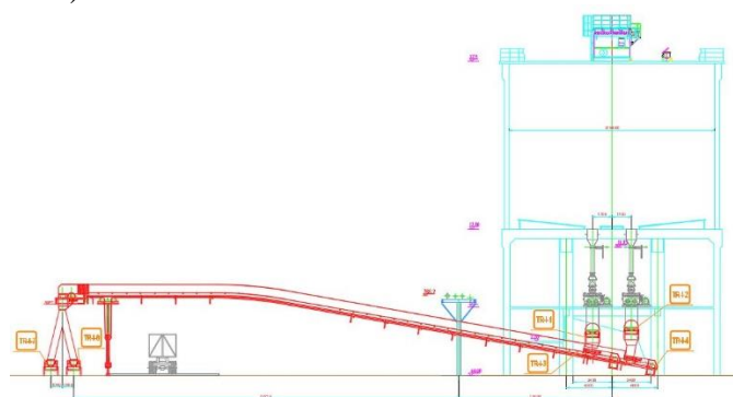
Sl. 4. Presip sa transportera TR-I-3 i TR-I-4 na zbirne transportere TR-I-7 i TR-I-8
