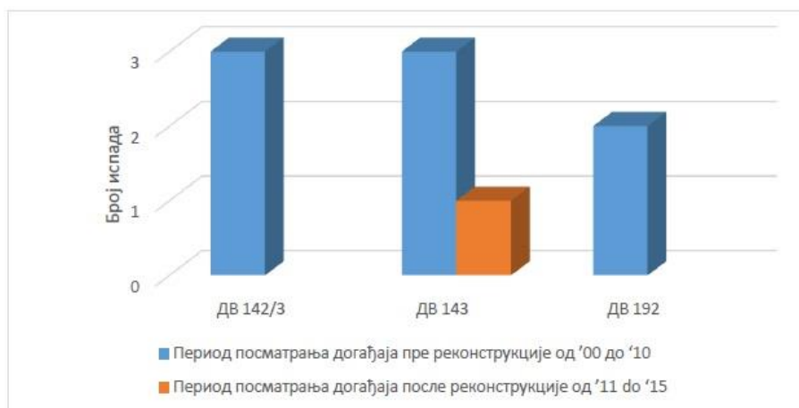
Sl. 12. Ispadi DV polja 110 kV pre i posle rekonstrukcije u TS Zrenjanin 2
