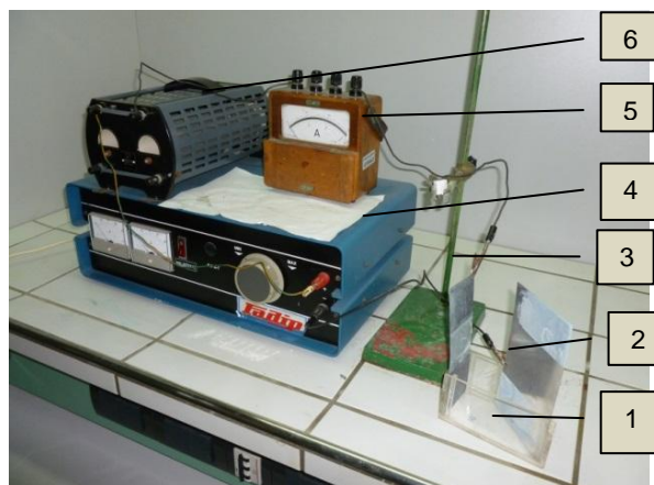
Slika 10. Izgled aparature za ispitivanje strukture cinkovog depozita u Hulovoj ćeliji: 1 - Hulova ćelija; 2 - Katoda; 3 - Anoda; 4 - Ispravljač; 5- Amperemtar; 6 – Otpornik
