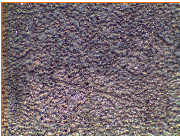
Slika 17. Struktura katodnog depozita dobijenog u Hulovoj ćeliji taloženjem iz rastvora sa: H_2SO_4 150g/dm^3 , 60g/dm^3 Zn^{2+} -jona, 7mg/dm^3 želatina i 5 % (vol.) CH_3OH
