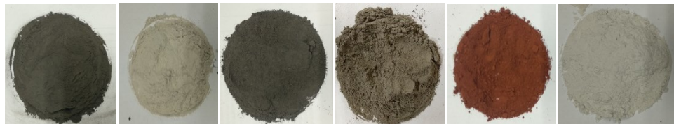
Slika 5. Materijali korišćeni u ispitivanju s leva: elektrofilterski pepeo, granulirana zgura, konvertorska zgura, pepeo drvene biomase, crveni mulj i otpadno staklo
