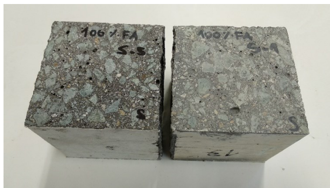
Slika 16. Izgled uzoraka geopolimernog etalona oznake „FA“: levo referentni uzorak, desno uzorak nakon 6 meseci od potapanja u 5 % rastvor \text{Na}_2\text{SO}_4
