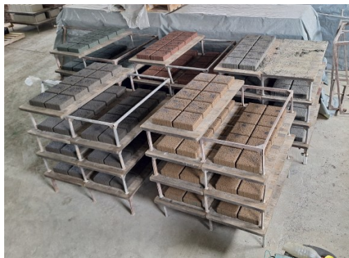
Slika 9. Proces proizvodnje poroznih betonskih ploča [15]
