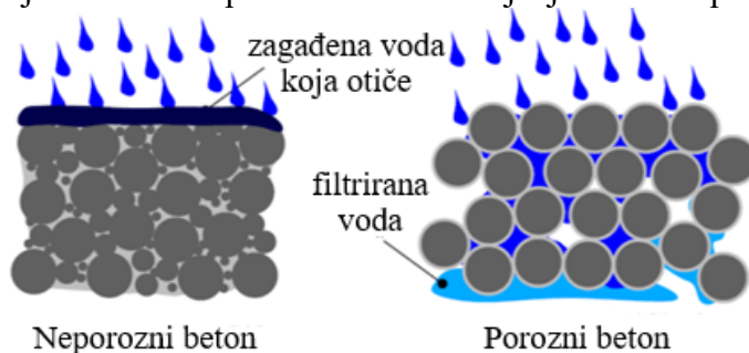
Slika 6. Penetracija vode u propusnom i običnom betonu [5]
