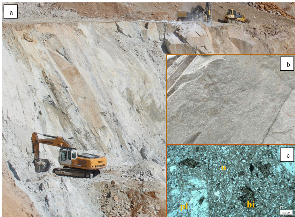
Slika 1. Čelo kamenoloma "Ćeramide" (a), makroskopski uzorak odminiranog bloka (b), mikrofotografija dacita porfirske strukture sa fenokristalima plagioklasa - pl, biotita – bi i osnovne mase - om (c), (Izvor: N.Hrnjez pod a i b, april 2025)
