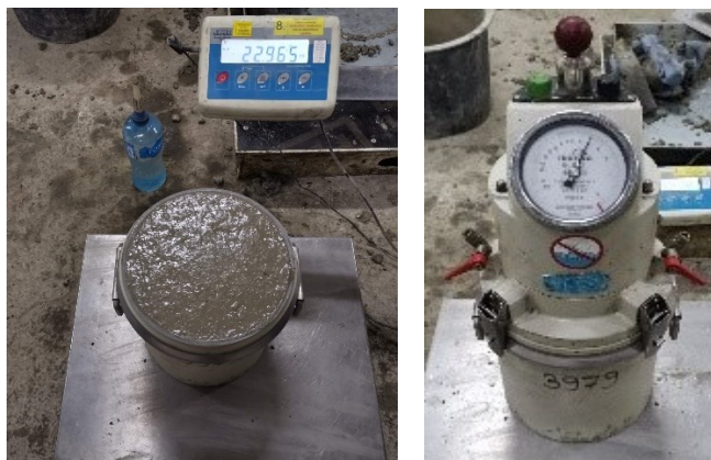
Slika 13. Postupak merenja zapreminske mase betona (levo) i merenje sadržaja vazduha (desno).
