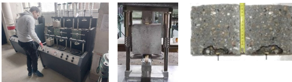
Slika 19. Aparatura za ispitivanje, cepanje uzorka i merenje dubine prodiranja vode
