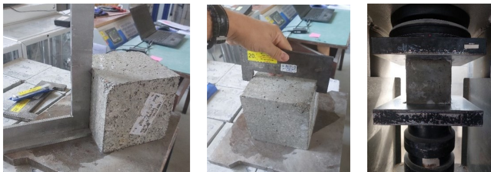
Slika 17. Određivanje čvrstoće betona pri pritisku
