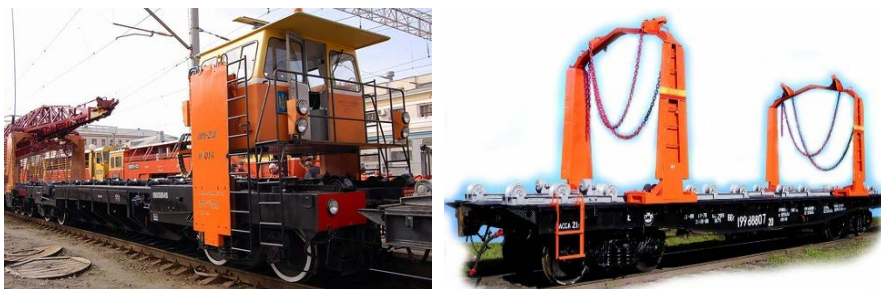
Figure 5 - Opened motor wagon MPD-2 and opened wagon USO [3] Slika 5 - Otvoreni motorni vagon MPD-2 i otvoreni vagon USO [3]
