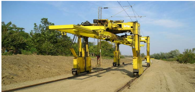
Figure 7 - Hidraulični motorni portalni kran DONELLI PD 350 [4]
