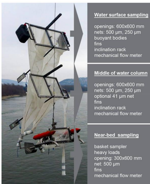
Слика 1 – Мерни уређај за мерење микропластике у рекама средње и велике величине [4]
