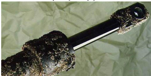
Sl. 4. Hidrauli ki cilindar "Ceramex" - Rexroth u agresivnoj sredini (morskavoda)
