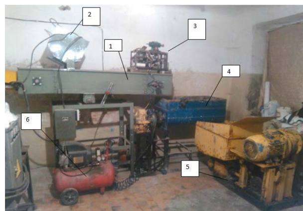
Sl.8. Tehnološki komplet opreme a) glavna šema tehnološkog kompleta opreme b) opšta slika tehnološkog kompleta opreme 1 – Napojni vod kaiša; 2 – Skladište za napojni vod kaiša; 3 – Rezač sintetičkog vlakna; 4 – Troosovinska betonska mešalica; 5 – Betonska pumpa sa pločastim ventilima; 6 – Kompresor.
