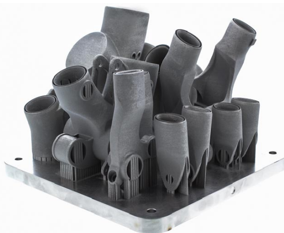
Sl. 3: Optimizovani oblik delova rama Robot Bik Co. [8]
