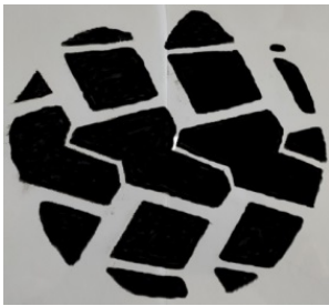
Slika 1: Otisak pneumatika prednjeg točka pri pritisku od 7.5 bara i opterećenju od 2395 daN (dimenzija fotografije 14.1*12.29, cm -533*487 Piksela)
