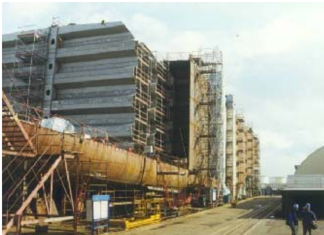
Slika 4. Opšti izgled rezervoara za prevoz hemikalija na palubi
