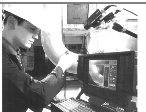
Slika 5: UT sa C-slikom korodiranog kolena cevi sa praćenjem video kamerom
