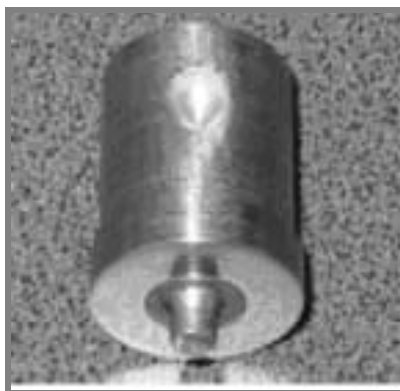
Slika 7: Alat za zavarivanje sa cilindričnim trnom Figure 7: Cylindrical threaded welding tool
