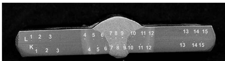
Slika 7. Makrostruktura i raspored mesta merenja tvrdoća u ispitnom spoju
