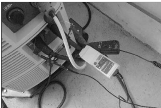
Slika 2. Mjerenje jačine struje i snimanje profila struje i napona pri zavarivanju
