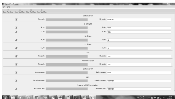
Slika 13: Praćenje izvršenja DES algoritma u aplikaciji CryptoWorkflow
