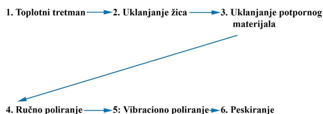
Slika 7. Shematski prikaz tipičnog procesa naknadne obrade (engl. postprocessing ) 3D štampe metala.
