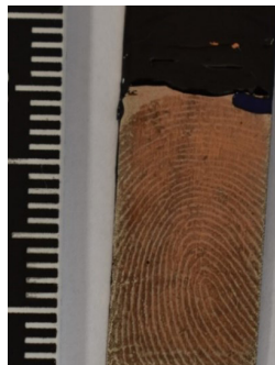
Слика 4в. Фотографија шрапа папиларних линија изазваној методом шаложења мейала (Ni на шлочи Cu) 6
