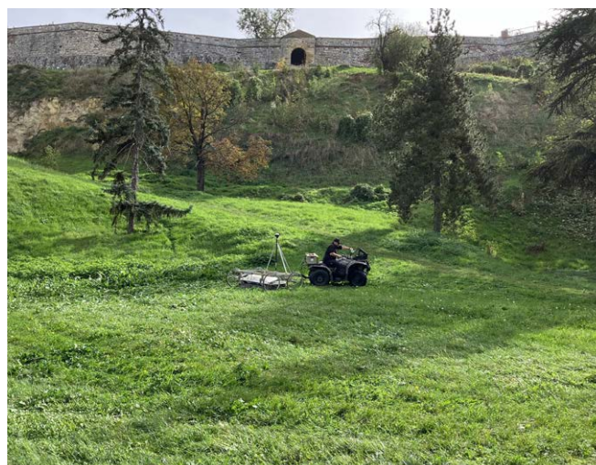
Сл. 10. Геофизичко мерење у Доњем граду, октобар 2023. године – моторизовани уређај Malå Mira HDR GPR са RTK-GNSS пријемником (извор: GeoSphere Austria, Department Near Surface Geophysics )
