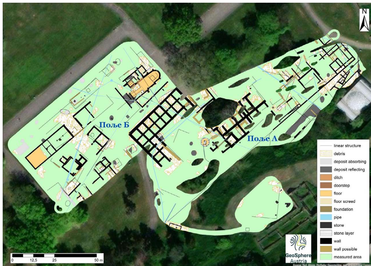
Сл. 12. Кумулативна интерпретација свих дубинских пресека и мањине пројекције (извор: GeoSphere Austria, Department Near Surface Geophysics)
