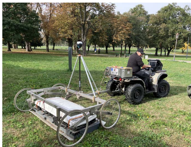
Сл. 10. Геофизичко мерење у Доњем граду, октобар 2023. године – моторизовани уређај Malå Mira HDR GPR са RTK-GNSS пријемником (извор: GeoSphere Austria, Department Near Surface Geophysics )
