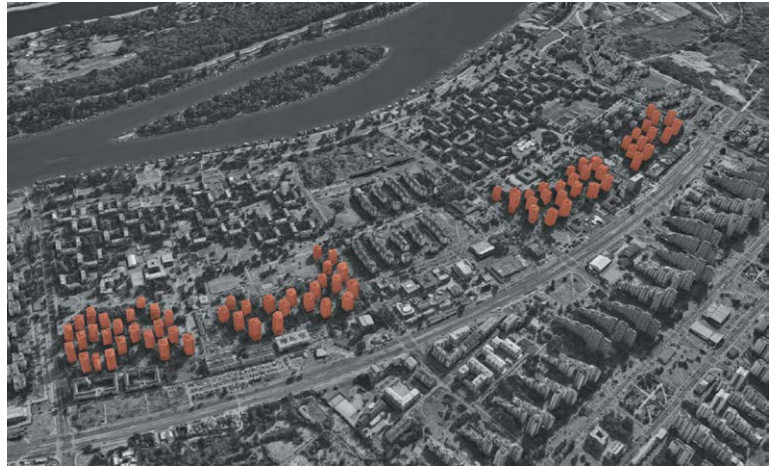
Сл. 6. Тийска основа сџамбених солиџера у Насељу сунца, сџрајиносџ П+8, ауџор: арх. Михаило Чанак, извођачи: ГП 'Раг', 'Найрег', 'Рајко Миџровић', 1968–1972. (Блок 70, 1973–1975) Консџрукџивни сисџем: скелејни ИМС; и џриказ њихових џозиџија у блоковима 45 и 70 (извор: Ђорђевић 1980)
