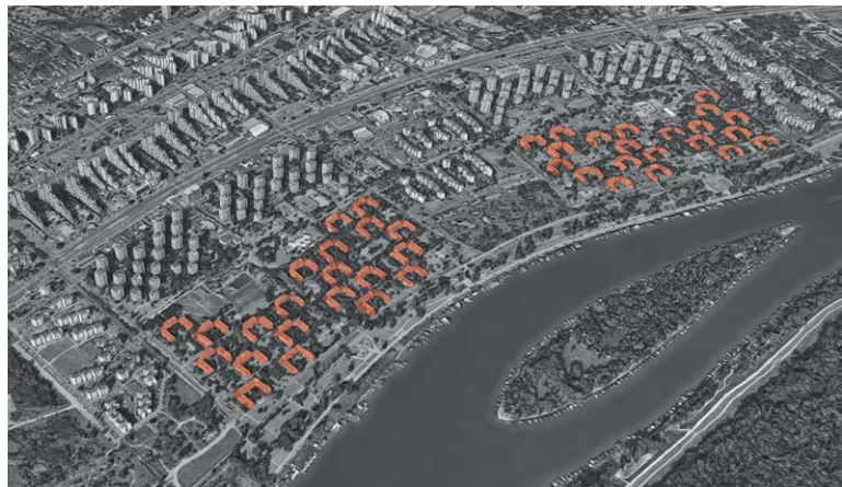
Сл. 7. Тийске основе сџамбених зџрада у облику џолуаџријума у Насељу сунца, сџрајиносџ П+4, ауџор: арх. Рисџа Шекерински, извођачи: ГП 'Неимар', '7. јули' и 'Трудбеник', 1968–1972. (Блок 70, 1973–1975) Консџрукџивни сисџем: џанелни монџажни; и џриказ њихових џозиџија у блоковима 45 и 70 (извор: Ђорђевић 1980)
