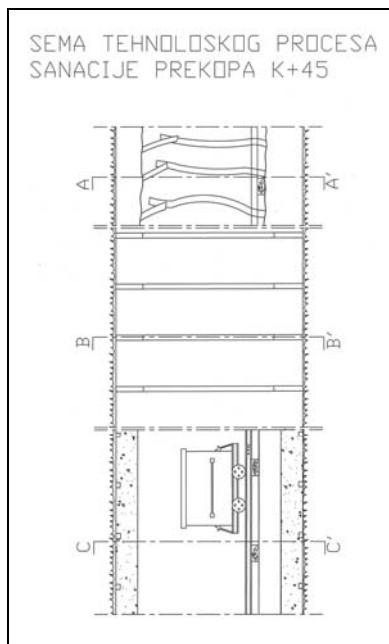
Rekonstrukcija prostorije vrši se putem sledećih radnih operacija: vađenje deformisane podgrade, obrada profila do projektovane veličine, utovar iskopanog materijala, privremeno podgrađivanje i odvodnjavanje.
