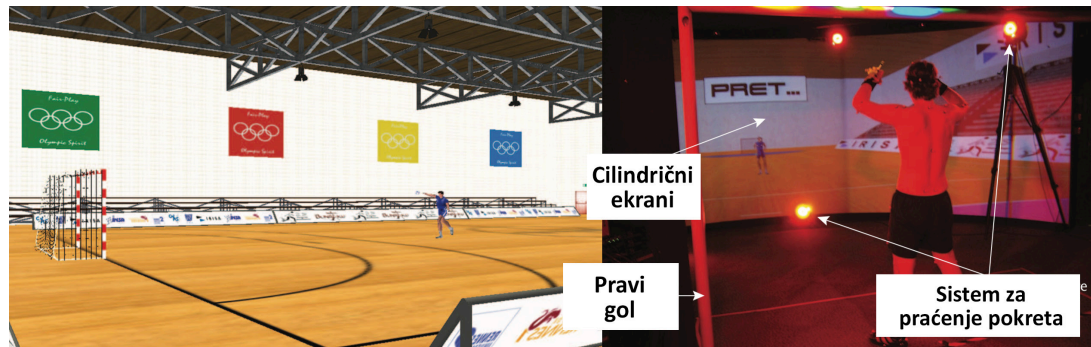
Slika 5. Prikaz virtuelnog okruženja i postavke opreme za trening rukometnog golmana korišćenjem VR tehnologije (Izvor: Bideau, Kulpa, Vignais, Brault, Multon, & Craig, 2010:69. Prilagodio Autor)
