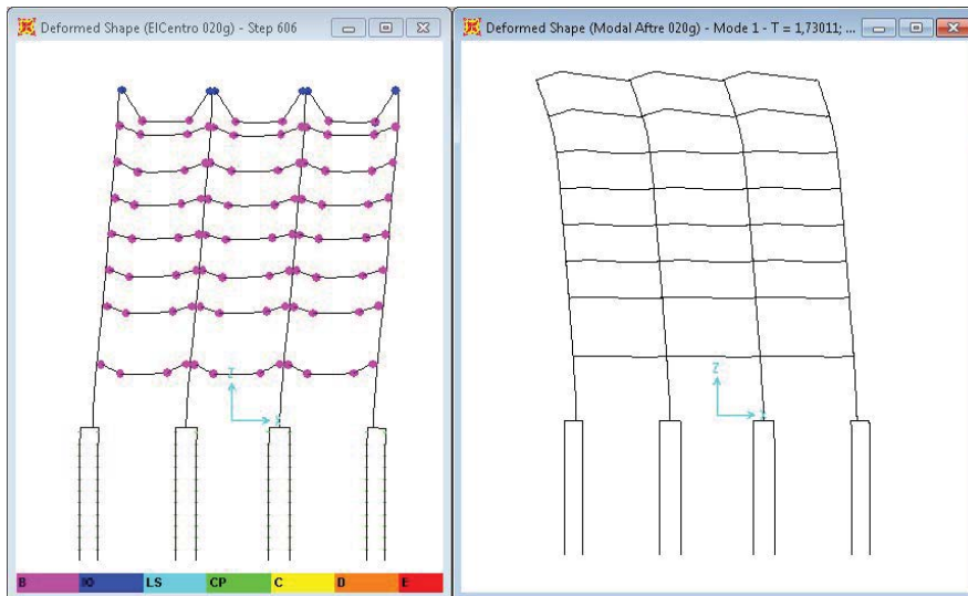
Slika 27. El Centor 0,20g stanje na kraju zemljotresa. Levo) plast. zglobovi: 90 Y + 6 IO; desno) oblik 1 vibracija Figure 27. El Centro 0.20 g. State at the end of an earthquake. Left, PI Hinge state: 90 Y + 6 IO. Right, Mode 1.
