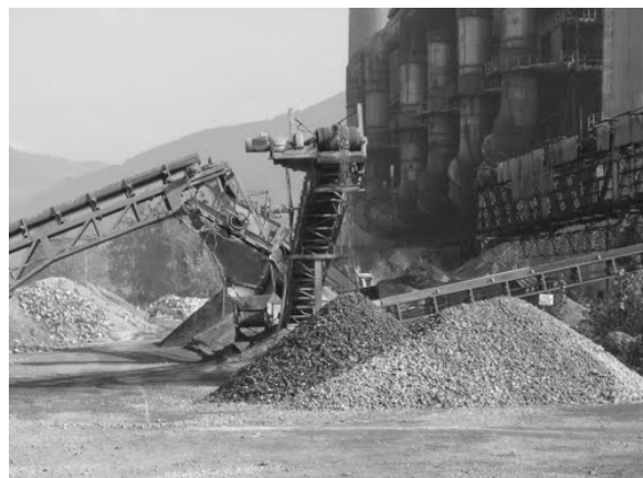
Slika 2. Uzorci materijala – frakcije zgure (lijevo) i postrojenje separacije (desno) Figure 2. Samples of material – slag fractions (left) and separation plant (right)
