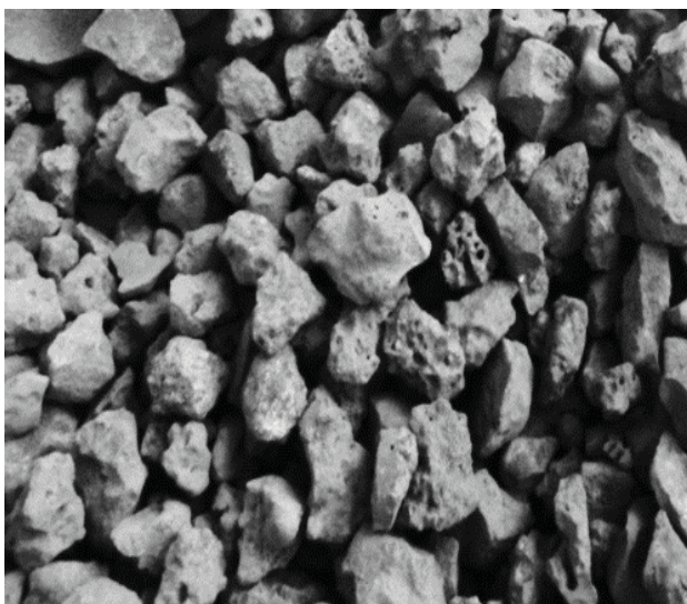
Slika 3. Uzorci materijala – frakcije zgure (lijevo) i postrojenje separacije (desno) Figure 3. Samples of material - slag fractions (left) and separation plant (right)
