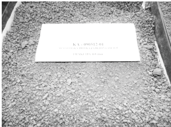
Slika 2. Uzorci materijala – frakcije zgure (lijevo) i postrojenje separacije (desno) Figure 2. Samples of material – slag fractions (left) and separation plant (right)
