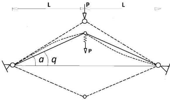
Figure 4 – a. The Von Mises truss
