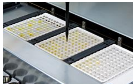
Slika 2. Mikrotitarske ploče sa automatizovanim sistemom očitavanja rezultata na ELISA procesoru
