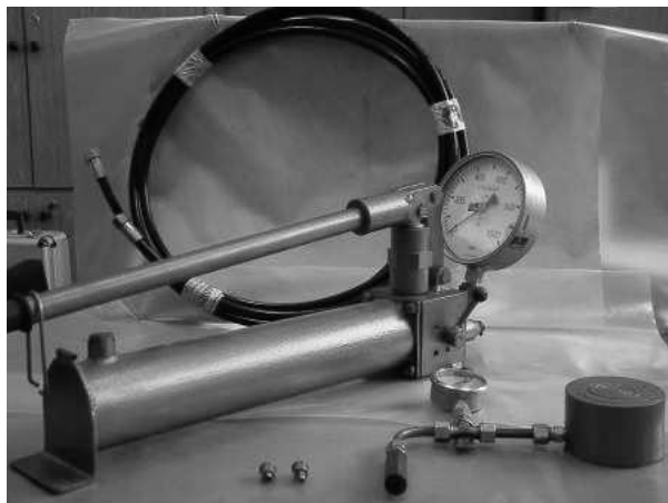
Sl. 3. Merna sonda sa dodatnim alatima za merenje naponskih stanja
