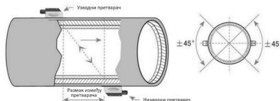
Слика 2. Метод рада ултразвучног мерача
