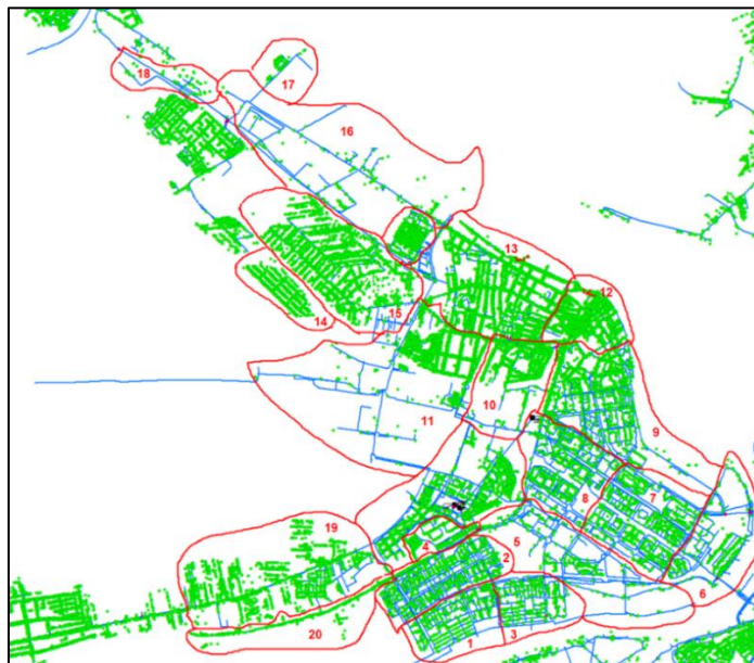
Slika 2. Georeferencirani vodomeri i njihovo grupisanje u fiktivne poligone u OZB Novi Beograd
