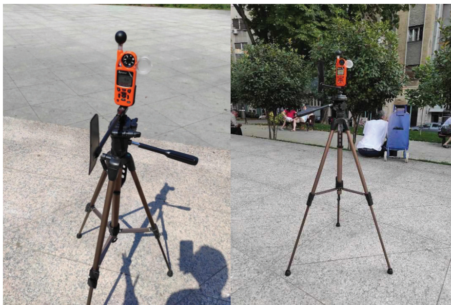
Slika 1: Mikrometeorološko merenje, Obilićev venac, uređaj Kestrel 5400 Heat Stess Tracker, avgust 2021.
