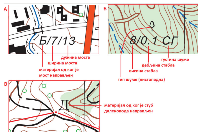
Слика 2: Врсте исписа на ТК25 за: мост (А), шуму (Б) и стуб далековода (В)
