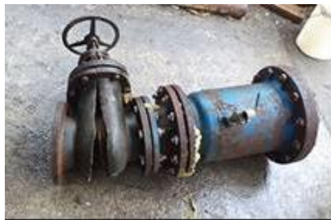
Слика 9. Мост Лучани истицање услед мразом изазваног пуцања засуна, и сам засун
