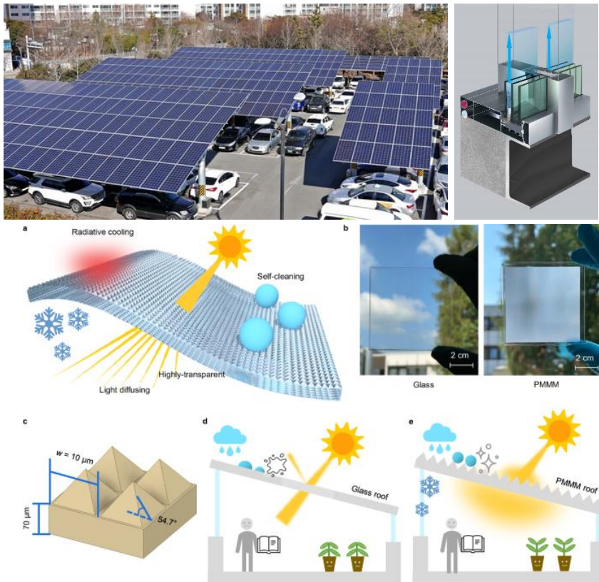
Слика 2. Приказ неких од активности из области технолошких решења. Горe лево – паркинг за електрична возила са пуњачима на соларну енергију; горe десно – прозорска стакла пуњена водом, детаљ; доле – приказ система радијативног хлађења
