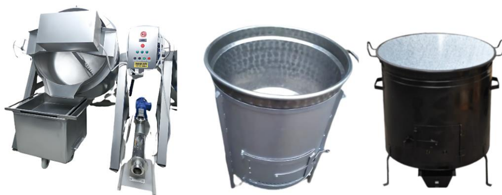
Slika 4. Tipovi kotlova i duplikatora za topljenje masnog tkiva.
