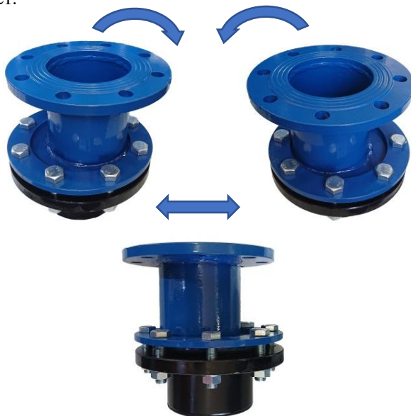
Слика 8. Приказ Вишеосног адаптера, као и изглед истог у случајевима када се тело спојнице ротира да би се кориговала постојећа несаосност
