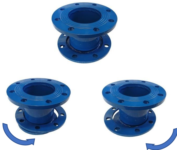
Слика 7. Приказ вишеосног адаптера, као и изглед истог у случајевима када се слободна прирубница ротира да би се повезала са постојећом
