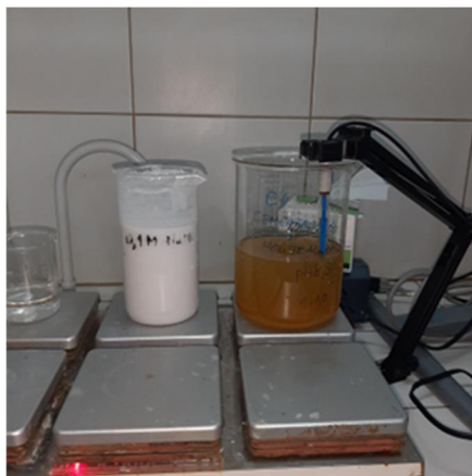
Слика 1. Неутрализација узорка након цементације Figure 1. Neutralization of the sample after cementation
