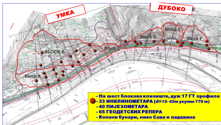
Слика 17: Диспозиција клизишта подељеног у шест блокова и распоредом инклинометара (2005–2007)
