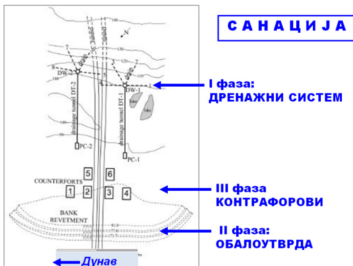
Слика 8: Диспозиција санационих мере на клизишту Мост слободе, према пројекту Института за путеве, Београд, 1995.
