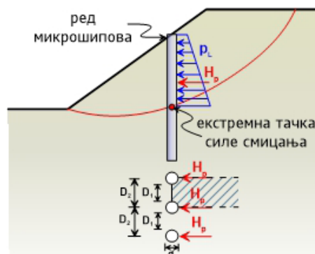
Слика 7: Прорачун геотехничке носивости микрошипова
