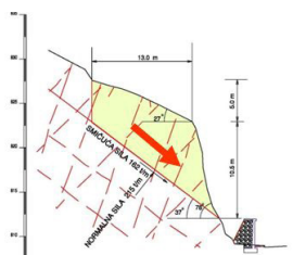
Слика 10: Анализа стабилности блока бр. 6 по раседној пукотини
