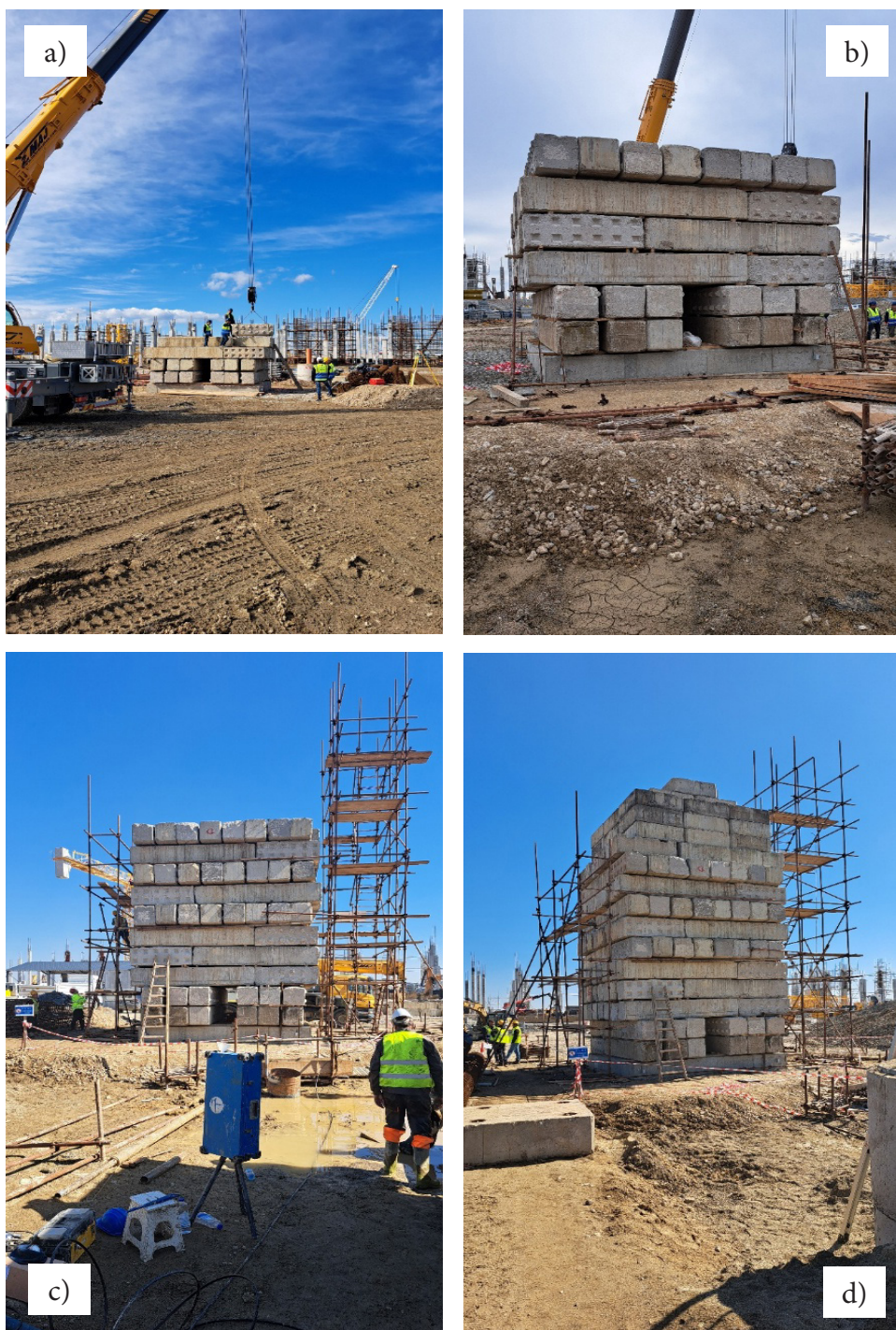
Slika 3: Fazno opterećenje ZLT-1, a) 13. 3. 2025 ( \approx 25\% ); b) 14. 3. 2025 ( \approx 50\% ); c) 19. 3. 2025 ( \approx 75\% ); d) 20. 3. 2025 (100%)
