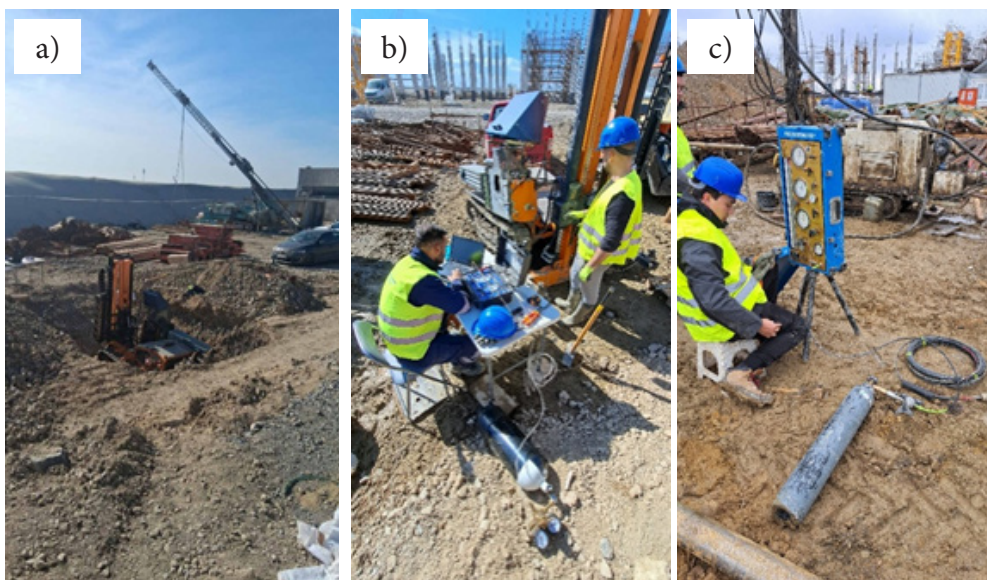
Slika 5: Izvođenje „in situ“ opita a) CPTu u jami u zoni ZLT-2; b) SDMT opit u zoni ZLT-1; c) Menardov presiometarski opit u bušotini B-4
