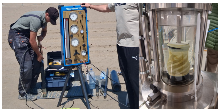
Slika 1: Menardov presiometar i triaksljalni uzorak
