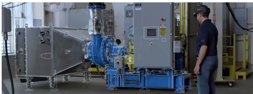
Слика 2. Преклапање дигиталног модела са физичким моделом
