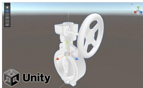
Слика 11. Развој Unity AR апликативног решења за препознавање вентила
