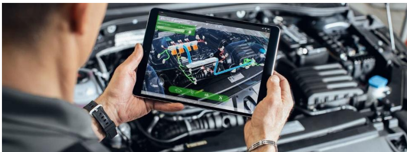
Слика 5. AR апликација за идентификацију компоненти
