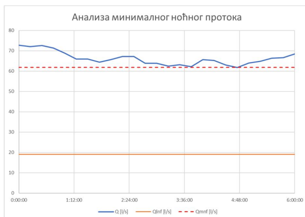
Слика 4. Дијаграм анализе минималног ноћног протока
